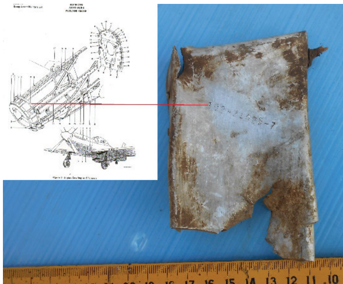
Dio s tvorničkim brojem i njegova pozicija na zrakoplovu
