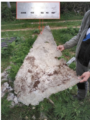
Vrh krila Spitfire s tvorničkim brojevima
