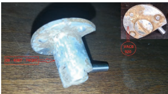
Vrh krila s tvorničkim brojem i dio s pečatom tvornice VACB – Vickers Armstrong Castle Bromwich
